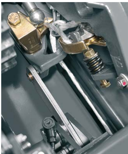
Ein Sensor misst die Fadenspannung. Droht dieser (trotz der federunterstützten Garnklemmung) aus dem Knoter zu rutschen oder gar zu reißen, reduziert sich der Pressdruck.
