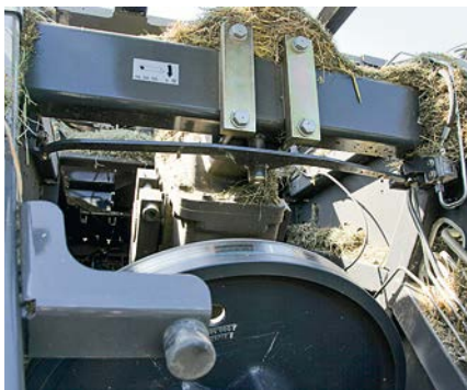
An der Traverse des Hauptgetriebes wird neben dem „Havarie-Ventil“ jetzt die Kolbenkraft für die Pressdruckregelung gemessen.
