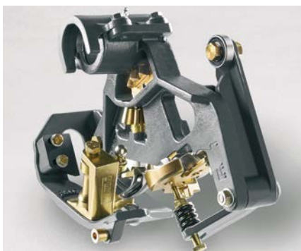
Der größere Winkel zwischen Garnklemmung und Knoterschnabel sorgt für längere Garnenden am Knoten. Der konische Schnabel mit größerer Öffnung erfasst das Garn besser, der Knoten gleitet leichter ab.
